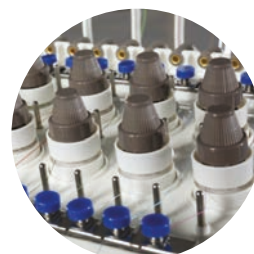
DETECCIÓN DE ROTURA DE HILOS DE HILOS
